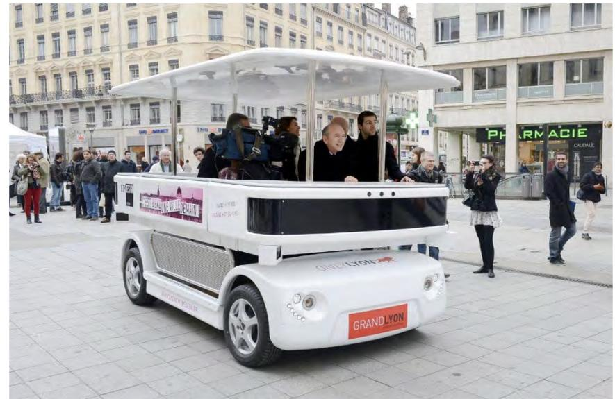
Le véhicule automatisé ne possède pas de commandes
